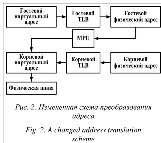
Рис. 2. Измененная схема преобразования адреса
