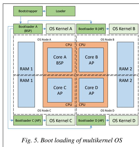
Fig. 5. Boot loading of multikernel OS
